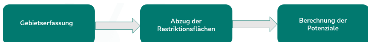
Abbildung 24: Grafische Darstellung des verwendeten Indikatorenmodells
